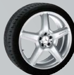
21 STYLE III AMG 5-spoke wheel 9 J x 21 ET 60 · FA 265/40 R21 B6 603 1204 Titanium silver finish
